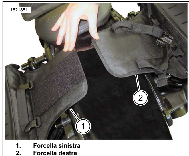
Figura 9. Installazione della forcella
