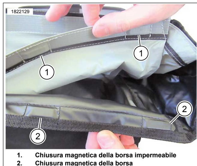
Figura 12. Installazione della borsa impermeabile
