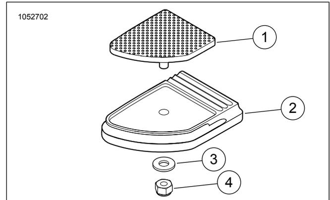
Figura 1. Parti di ricambio: Kit inserto del pedale del freno piccolo
