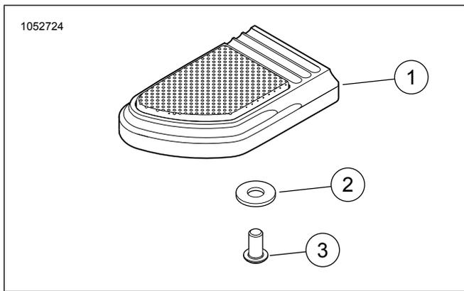
**Figura 2. Parti di ricambio: Kit inserto del pedale del freno grande**
