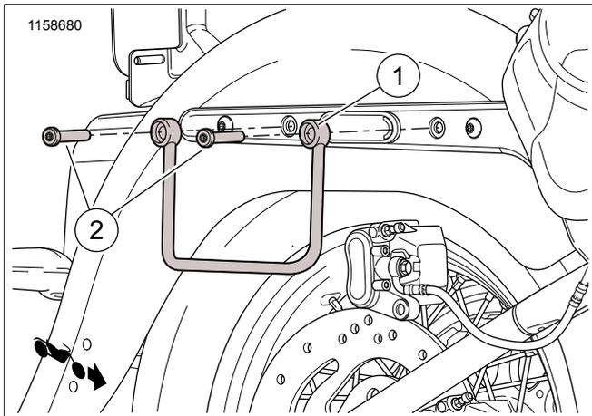
Figura 2. Parti di ricambio: Guide di sostegno delle borse
