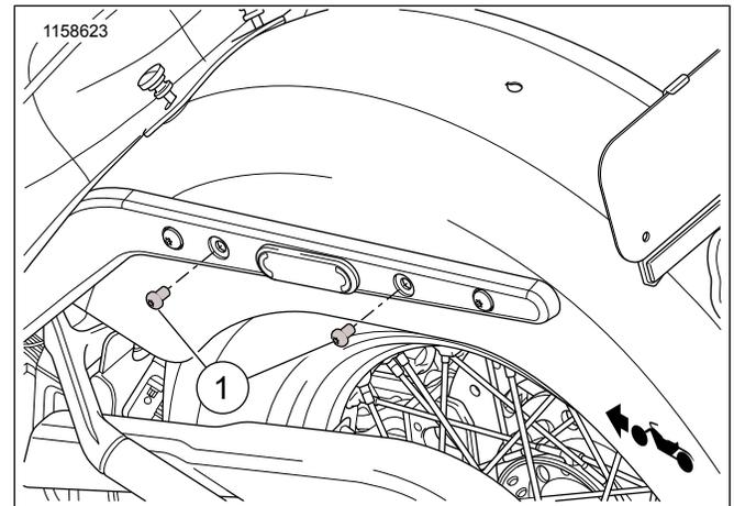
Figura 1. Rimozione viti - Parafrangente posteriore
