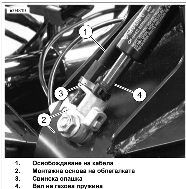
Фигура 6. Прикачване на кабела към монтажната основа на облегалката
