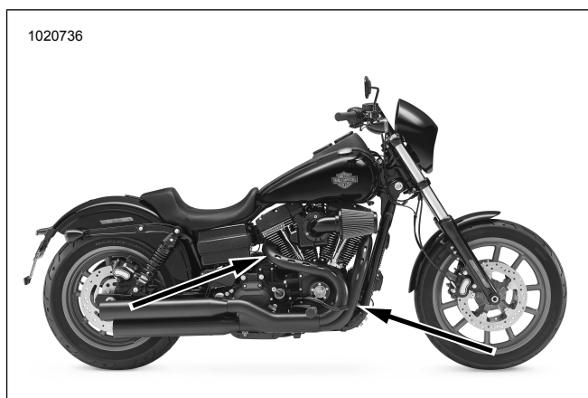
Rysunek 40. Położenie czujników tlenu (wewnętrzna strona rur wydechowych)
