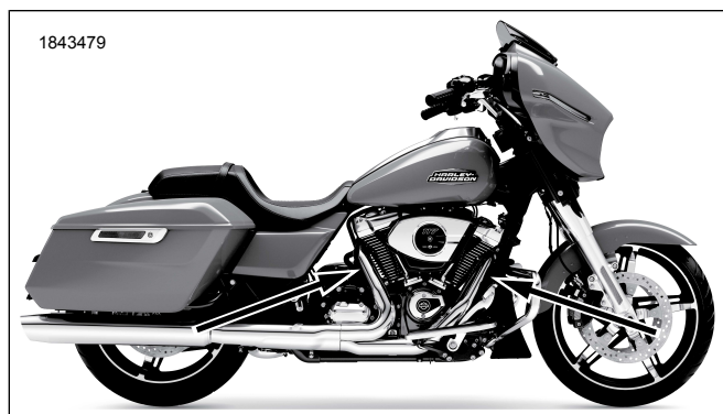
Rysunek 2. Położenie czujników tlenu (wewnętrzna strona rur wydechowych)
