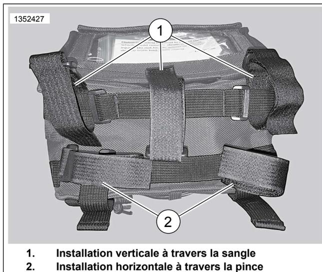
Figure 2. Options de fixation du ruban autograppant
