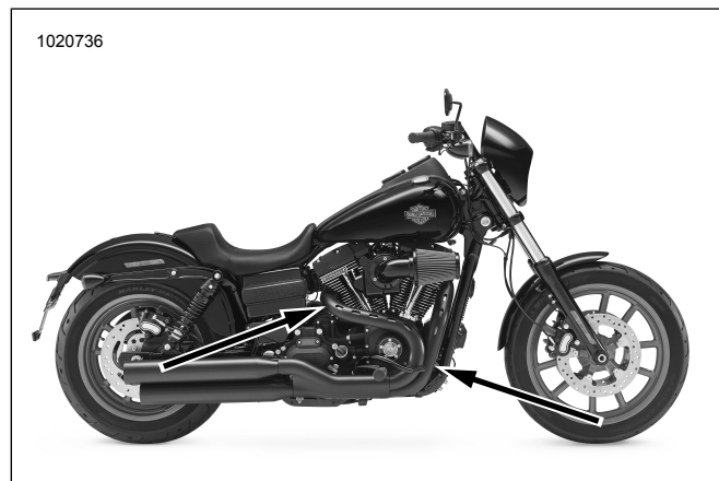
Figure 40. Emplacements de la sonde d'oxygène (côté intérieur des tuyaux d'échappement)
