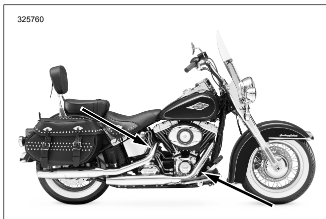
Figure 33. Emplacements de la sonde d'oxygène (côté intérieur des tuyaux d'échappement)
