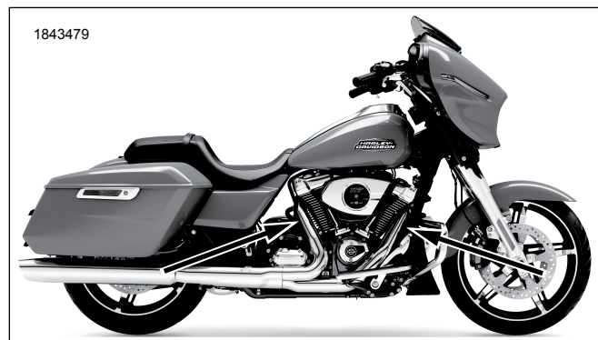
Figure 2. Emplacements de la sonde d'oxygène (côté intérieur des tuyaux d'échappement)
