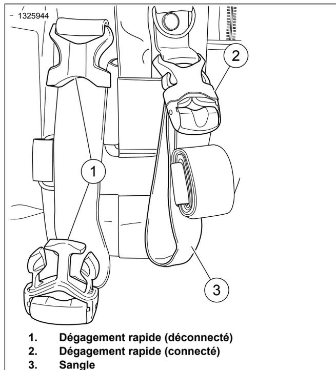
**Figure 2. Boucle à dégageur rapide**
