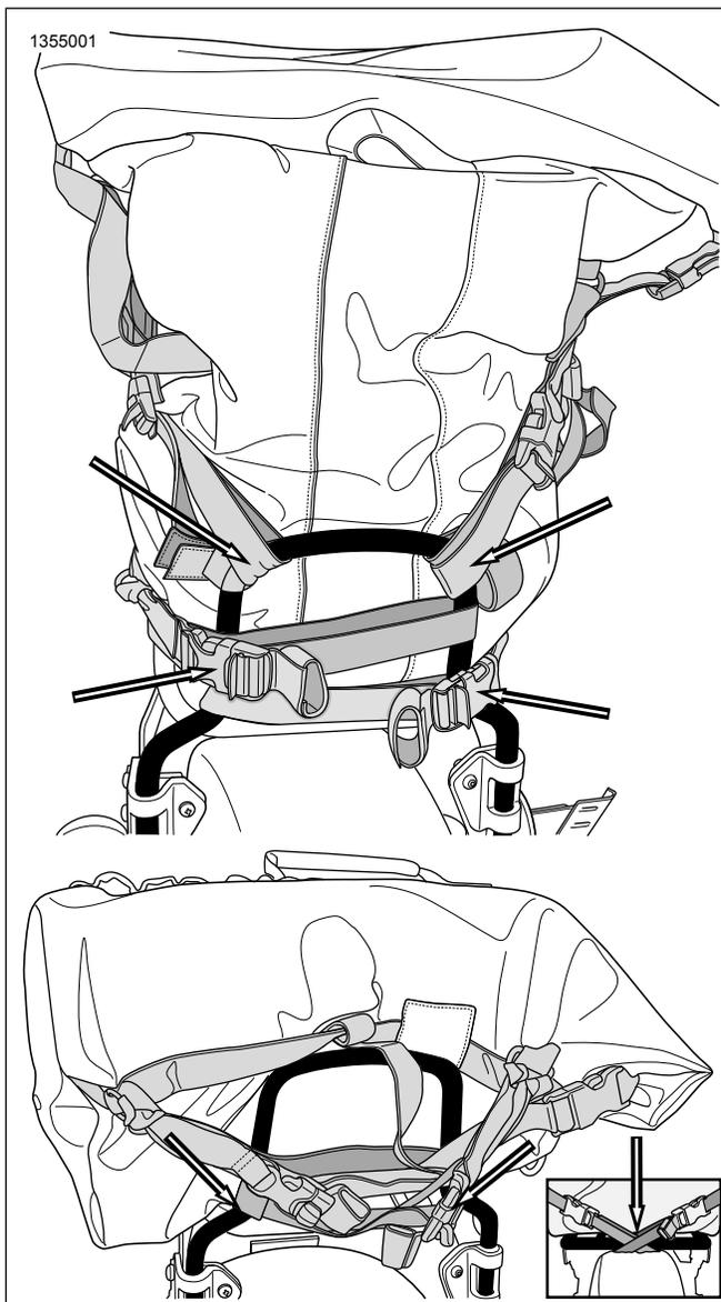
Figure 7. Fixation au porte-bagages
