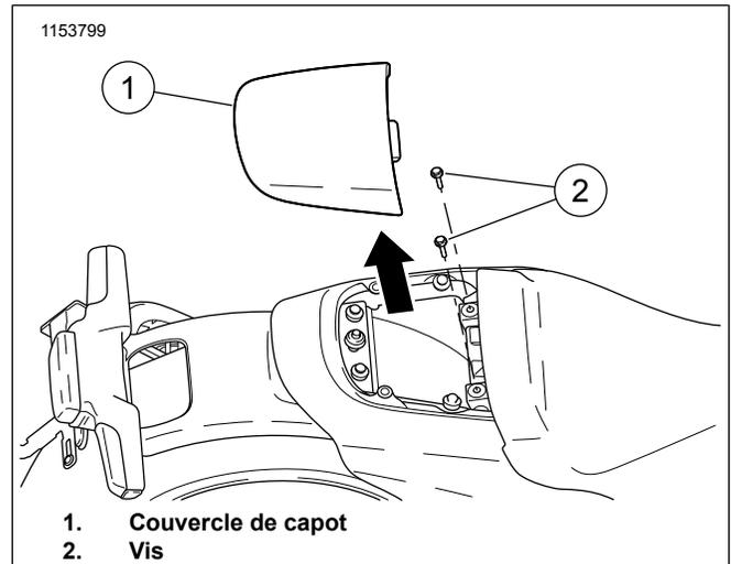
Figure 1. Couvercle de capot et retrait de vis
