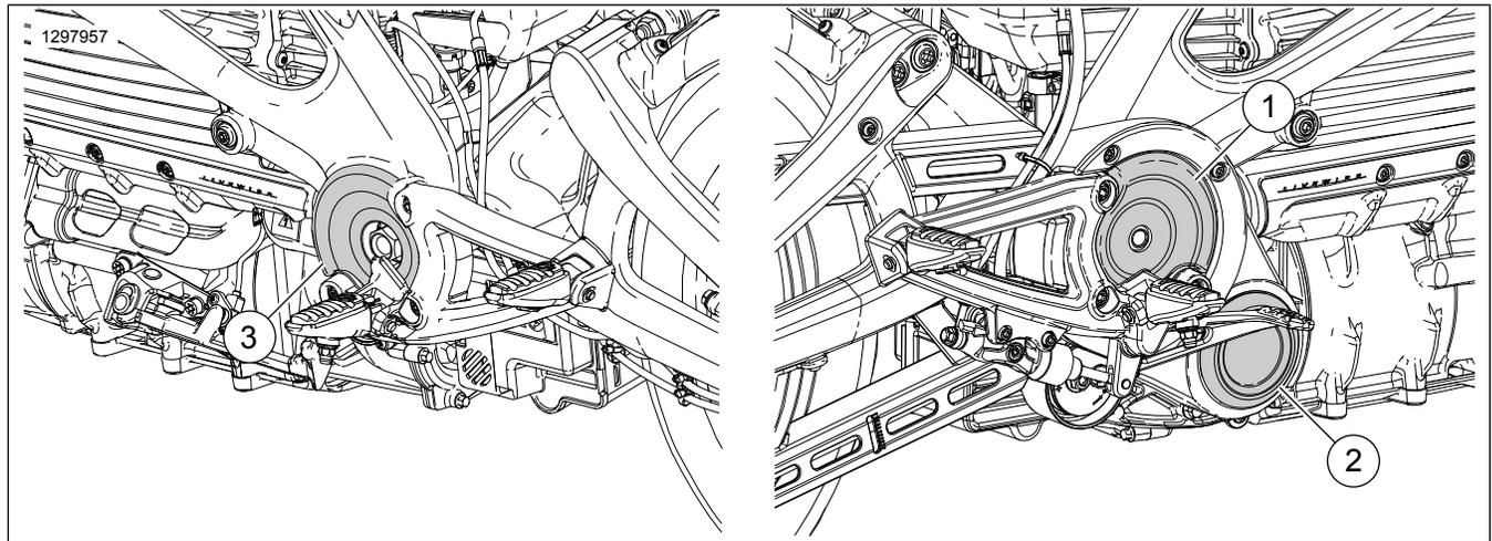
Figure 1. Contenu du kit : Caches d'habillage de transmission
