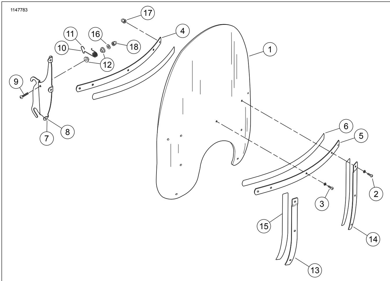
Figure 1. Pièces de rechange : Montage du pare-brise
