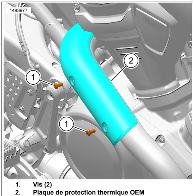
Figure 2. Plaque de protection thermique OEM
