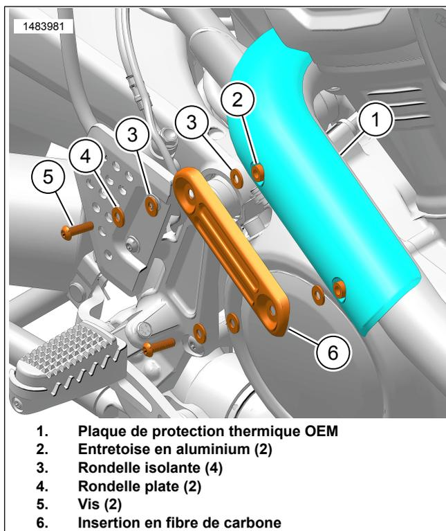
Figure 3. Insertion en fibre de carbone
