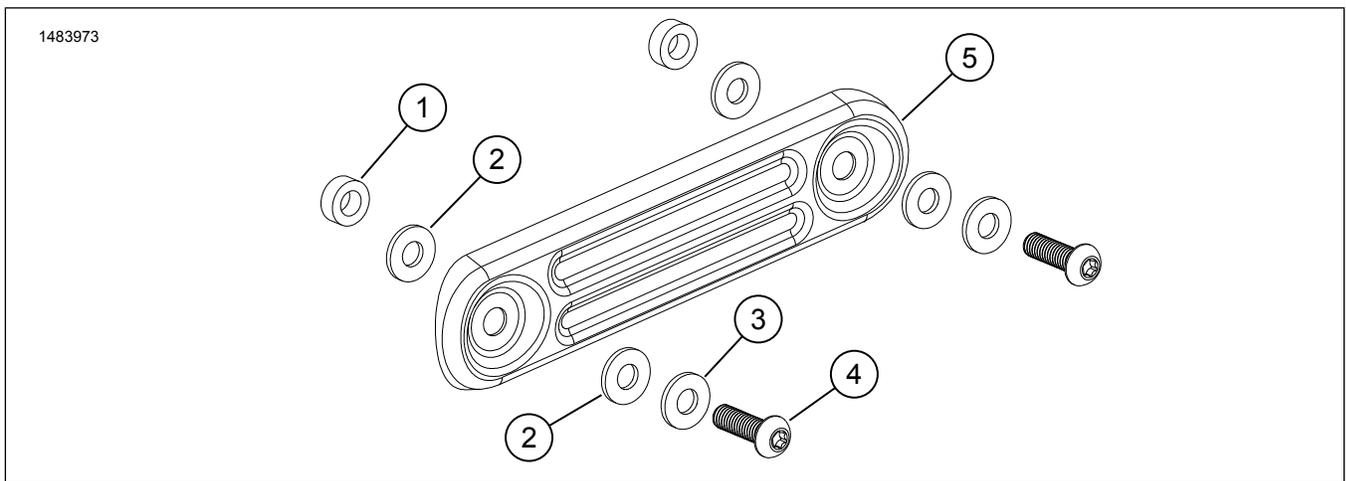
Figure 1. Contenu du kit : Insertion de plaque de protection de l'échappement en fibre de carbone
