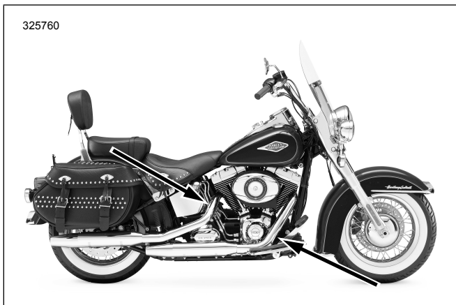
Hình 33. Các vị trí lắp cảm biến oxy (bên trong các ống xả)
