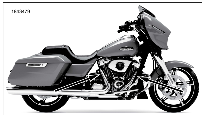
Figura 2. Localizações do sensor de oxigênio (lado interior dos tubos de escape)
