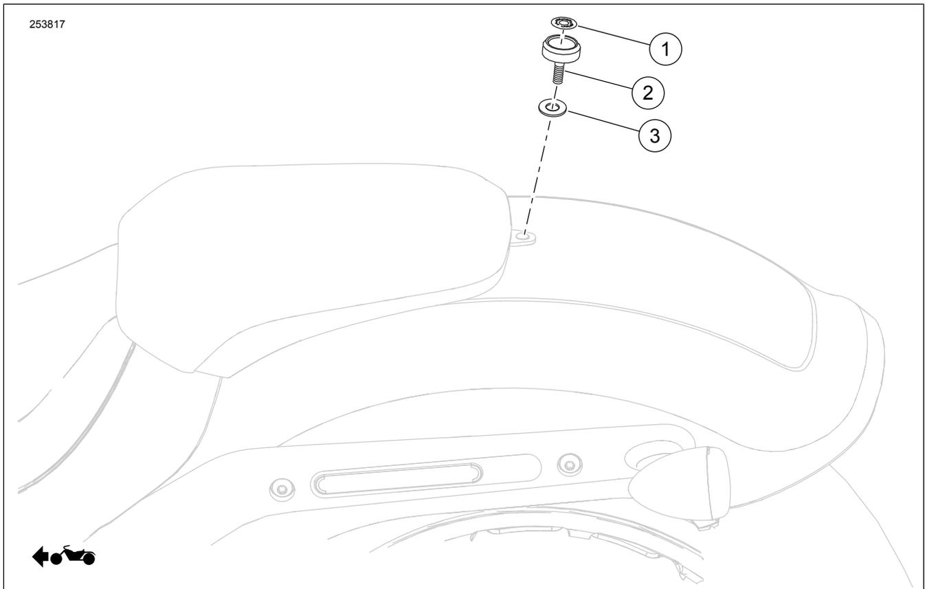
Figura 1. Conteúdo do kit: Componentes do apoio lombar do condutor
