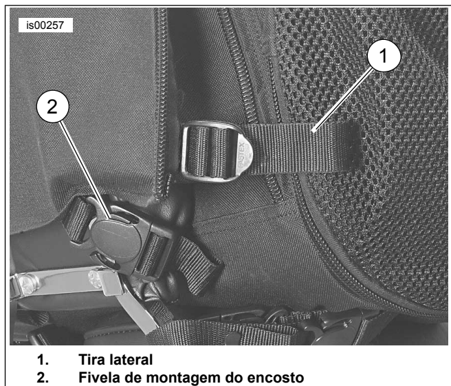
Figura 2. Tira lateral e fivela de montagem do encosto
