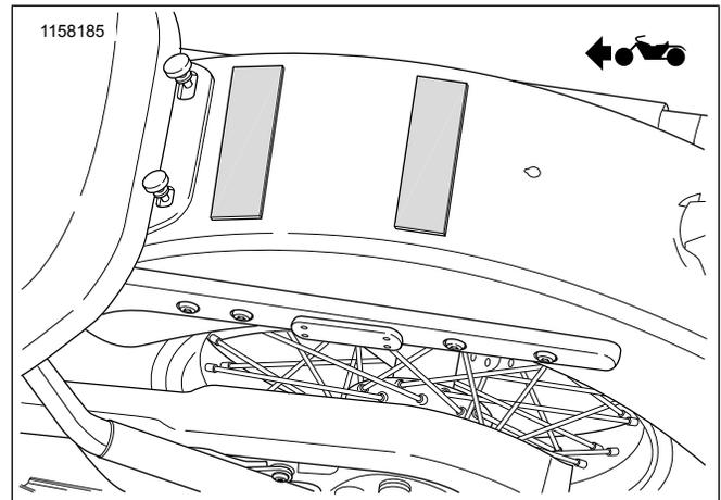
Figura 1. Colocação da fita antiabrasão
