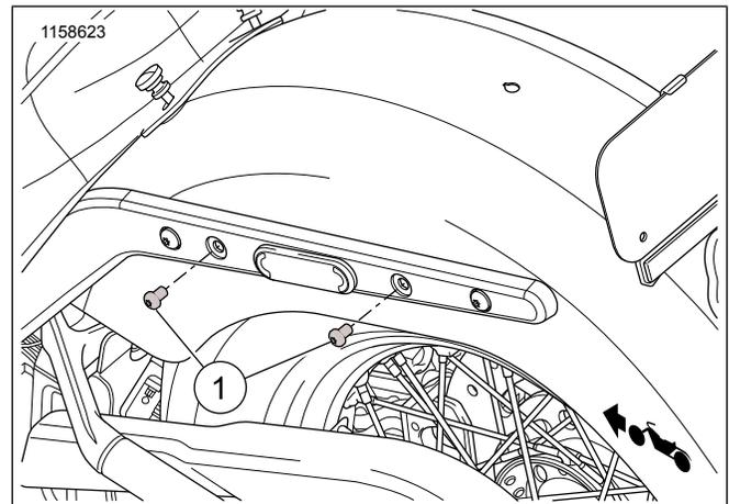
Figura 1. Remoção dos parafusos - Guarda-lama traseiro
