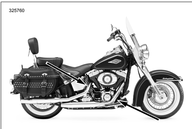
Kuva 33. Happitunnistimien sijainnit (pakoputkien sisäpuolella)
