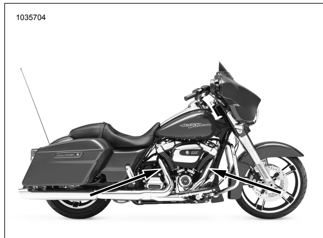
Kuva 11. Happitunnistimien sijainnit (pakoputkien sisäpuolelta)
