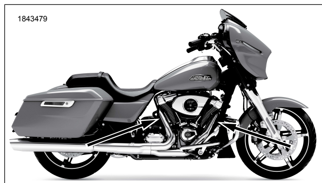
Figur 2. Placeringerne af iltfølere (indvendig side af udstødningsrør)
