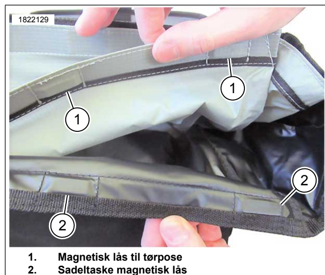
Figur 12. Installation af tørpose
