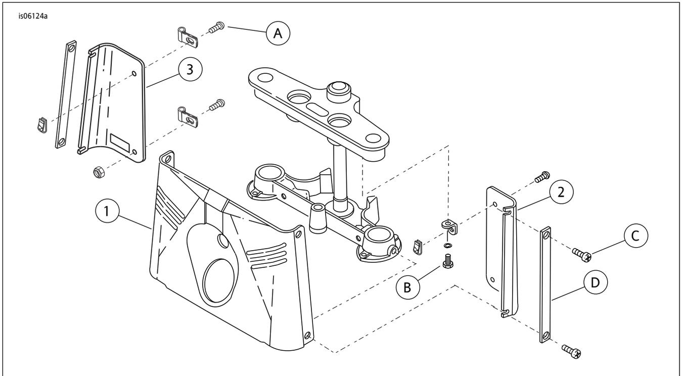
图1。维修零件：亮黑色三角轧头罩套件
