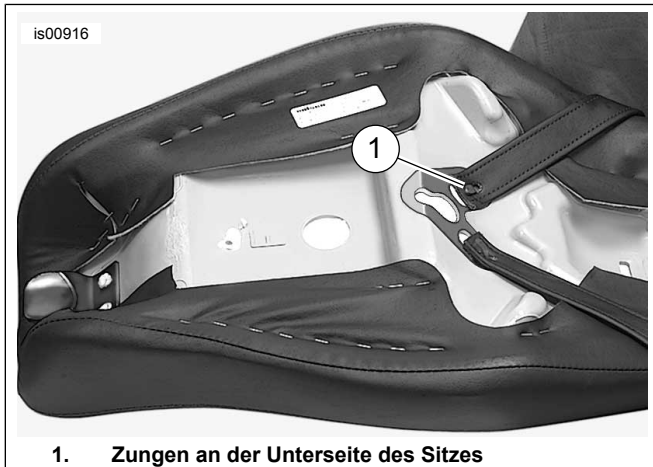
Abbildung 4. Sitzunterseite mit eingebautem Halteriemenn dargestellt
