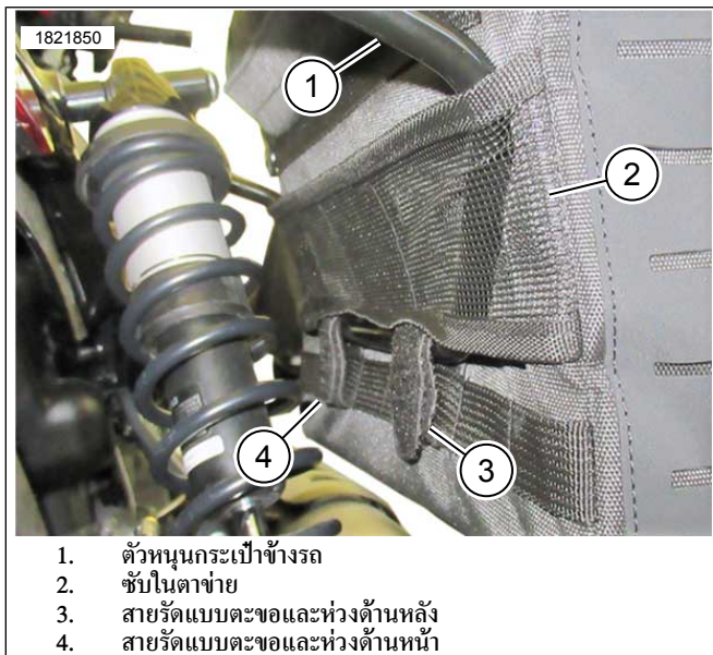
รูปภาพ 8 การติดตั้งกระเป๋าช้าง
