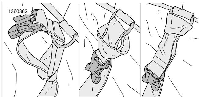
Figure 5. Sangle à boucle de déblocage rapide (93300138)
