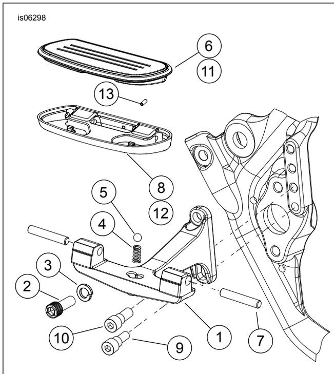
Figure 2. Pièces de rechange : Marchepied passager Streamliner
