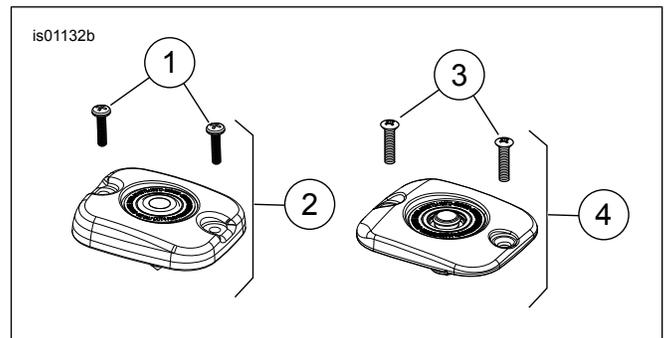
Figure 1. Pièces de rechange : Kits de couvercle de maître-cylindre
