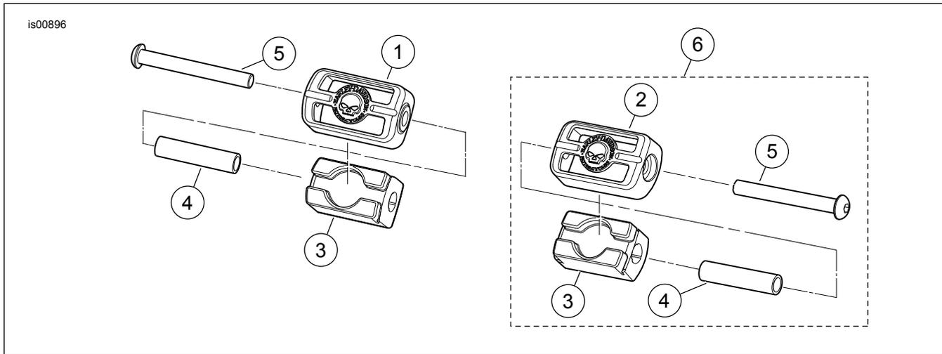
Figure 1. Pièces de rechange, kits de pédale de sélection de vitesse / patin de repose-talon Skull
