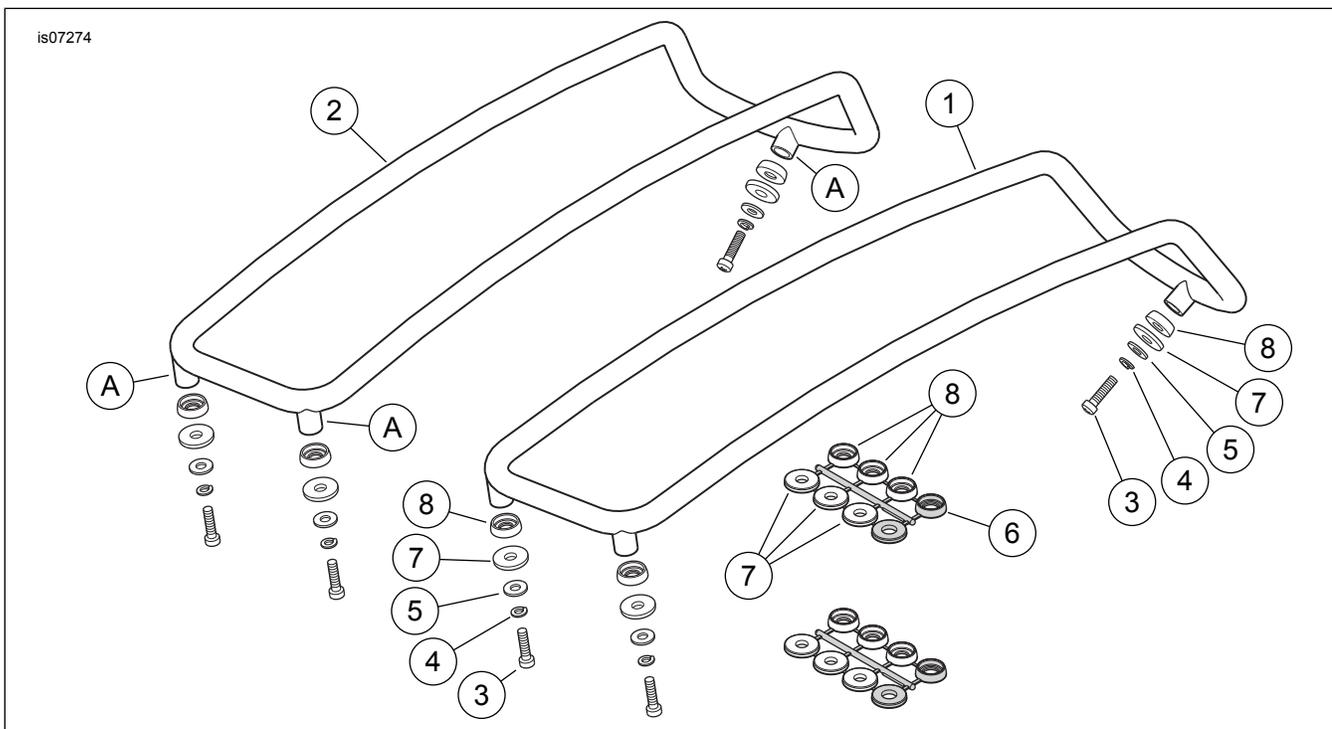
Figure 1. Pièces détachées, Kit rail de couvercle de sacoche Touring
