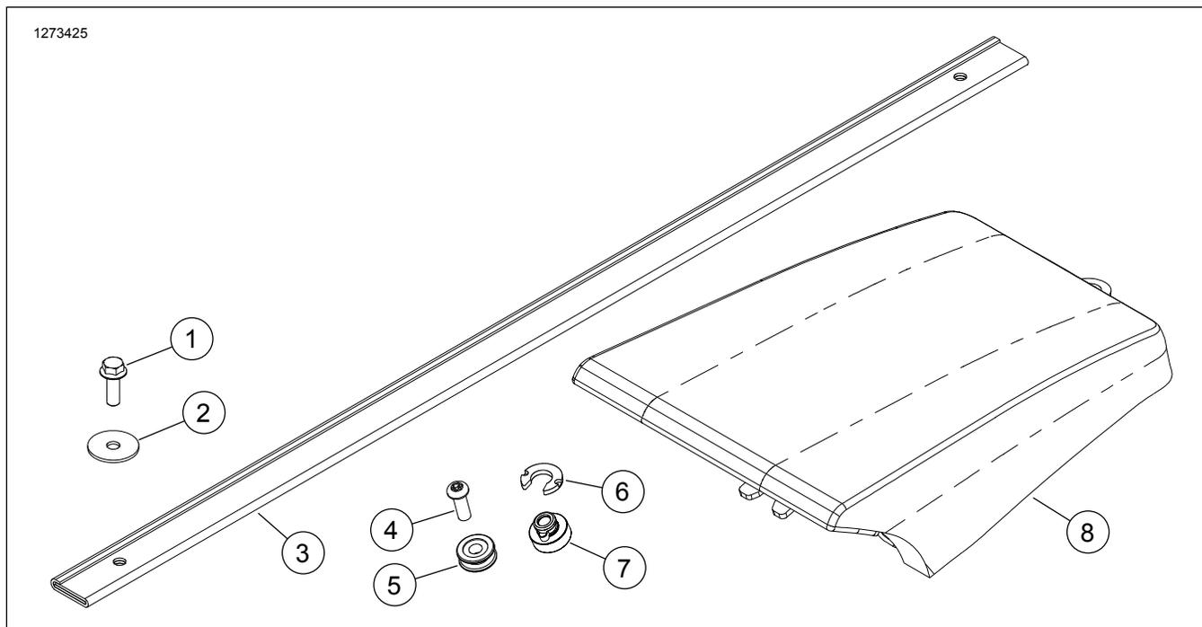
Figure 5. Pièces de rechange : Kit de siège du passager FXFB
