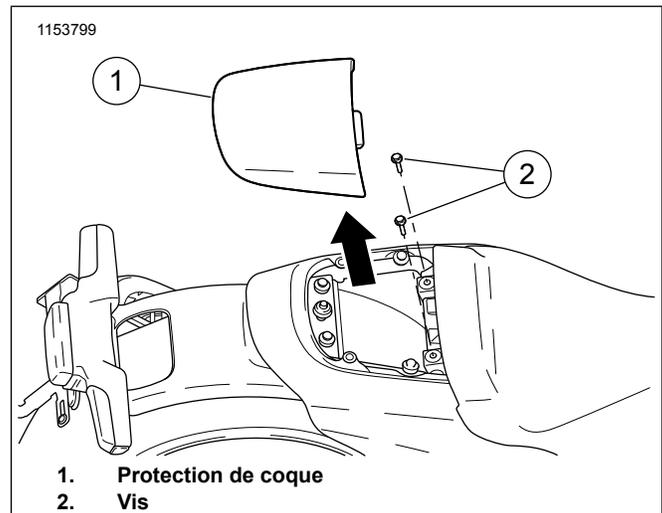
Figure 1. Dépose de la protection de la coque et des vis
