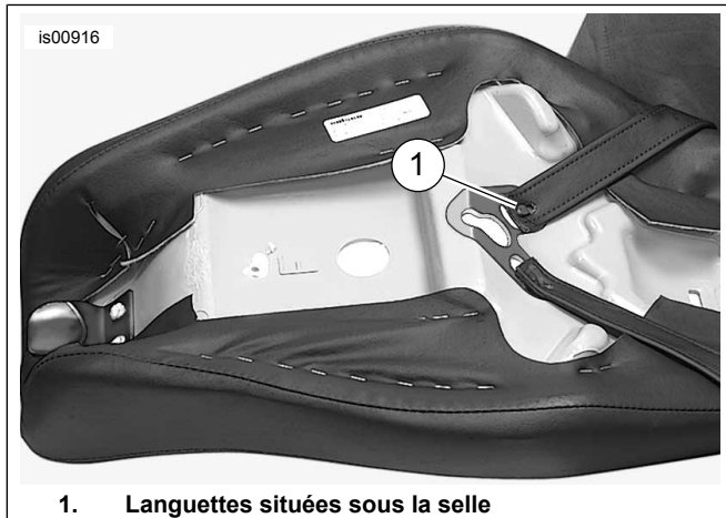
Figure 4. Partie inférieure de la selle montrant la sangle de maintien installée
