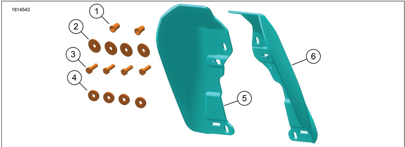
Figure 1. Contenu du kit : Déflecteur d'air central
