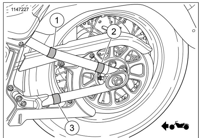
Figure 2. Positionnement du ruban anti-abrasion et de la fixation auto-agrippante
