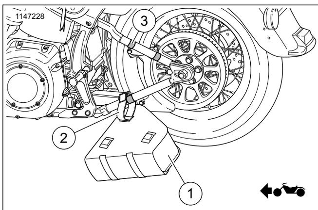
**Figure 3. Pièces de rechange : Kit de sac de bras oscillant Softail**
