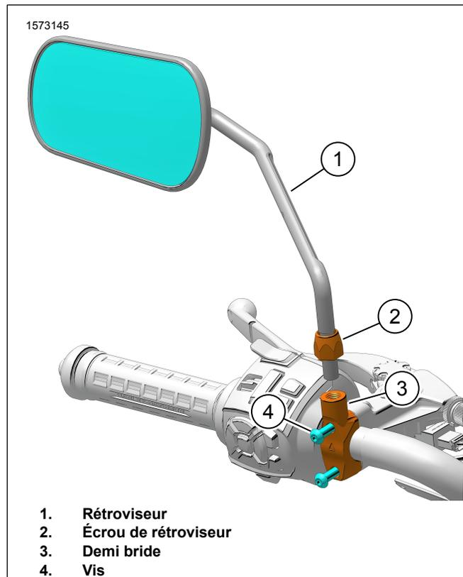
Figure 3. Ensemble rétroviseur
