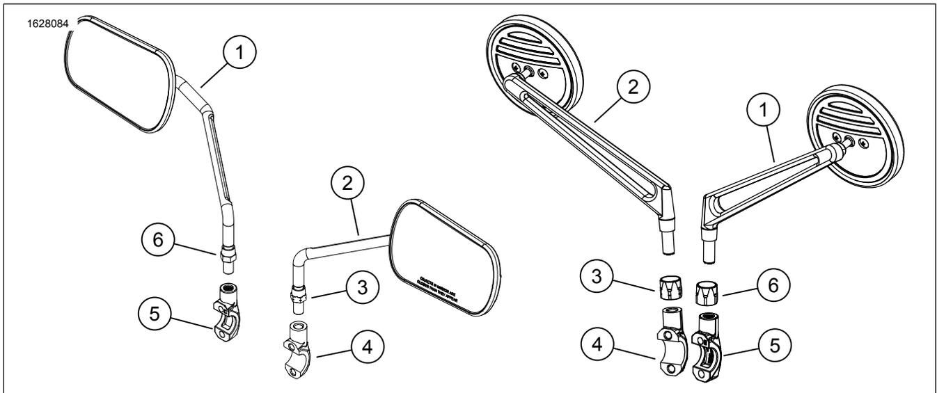
Figure 1. Contenu du kit : Kit rétroviseur
