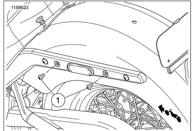
Figure 1. Dépose de vis – Garde-boue arrière
