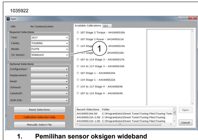
Gambar 17. Pemilihan Sensor Oksigen Wideband
