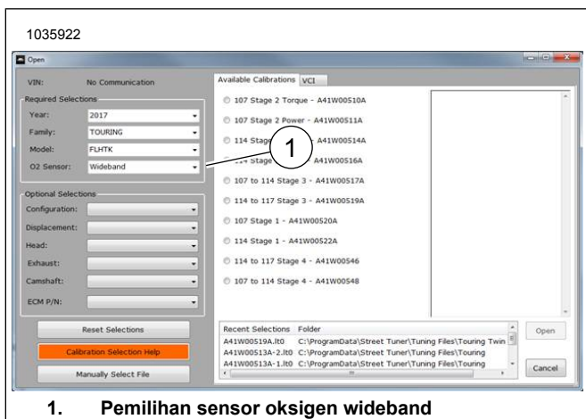
Gambar 45. Pemilihan Sensor Oksigen Wideband
