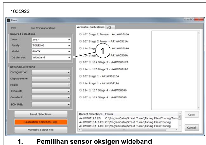
Gambar 51. Pemilihan Sensor Oksigen Wideband
