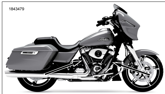
Gambar 2. Lokasi Sensor Oksigen (Sisi Dalam Knalpot)
