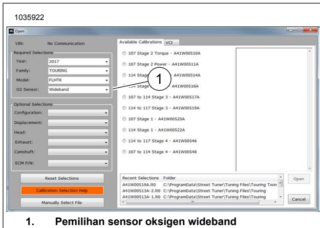
Gambar 26. Pemilihan Sensor Oksigen Wideband
