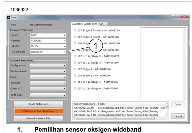
Gambar 9. Pemilihan Sensor Oksigen Wideband
