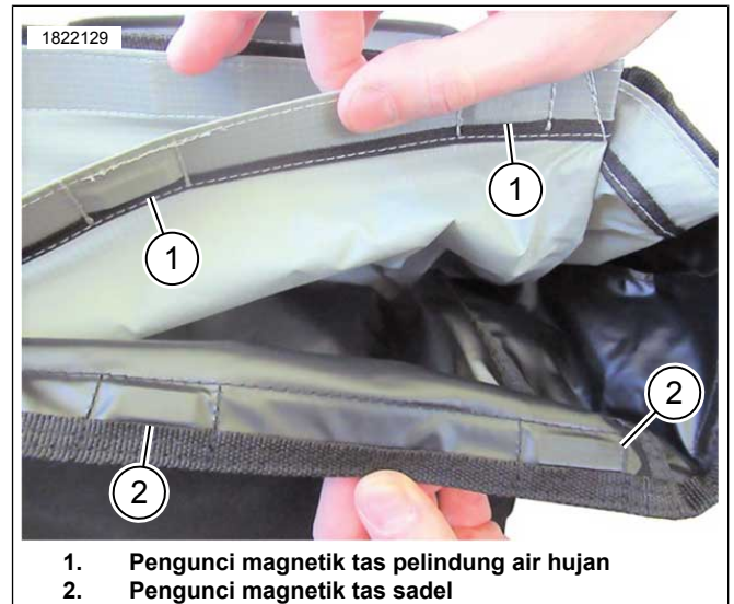
Gambar 12. Pemasangan Tas Pelindung Air Hujan
