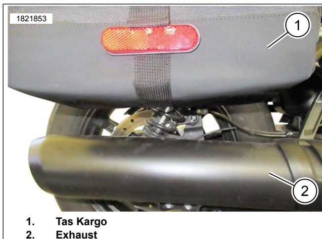
Gambar 11. Jarak Aman ke Knalpot
