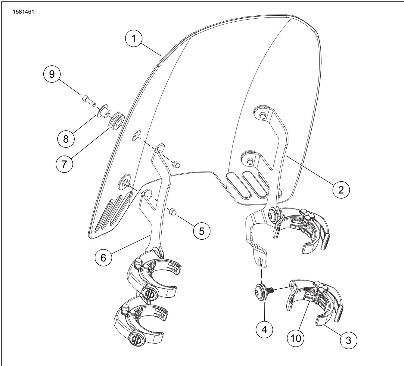
**Gambar 8. Isi Kit: Kit Kaca Depan Pelepasan Cepat (57400361) - FXDRS**
