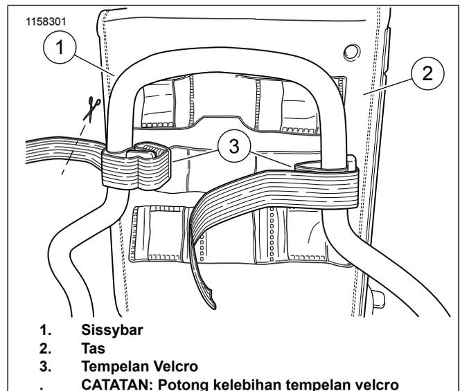
Gambar 2. Pemasangan Tas dan Tempelan Velcro
