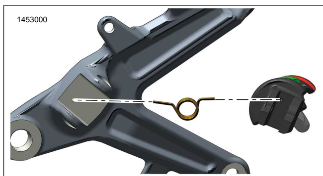
Ilustrace 5. Orientace vratné pružiny – pravá
