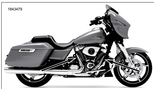
Ilustrace 2. Umístění snímačů kyslíku (vnitřní strana výfukového potrubí)
