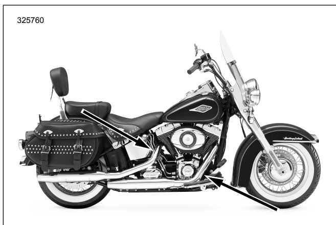
Ilustrace 33. Umístění snímačů kyslíku (vnitřní strana výfukového potrubí)
