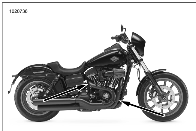
Ilustrace 40. Umístění snímačů kyslíku (vnitřní strana výfukového potrubí)
