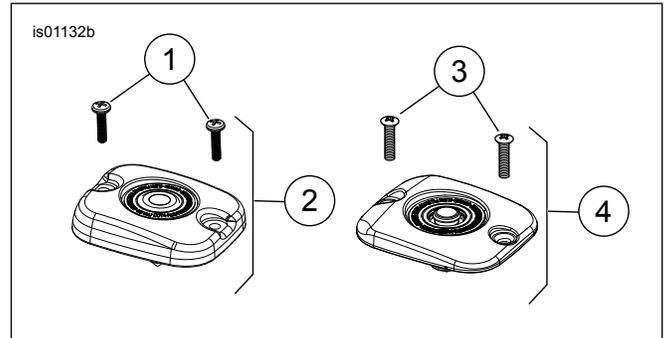
Figura 1. Piezas de servicio: Kits de cubierta de la bomba
