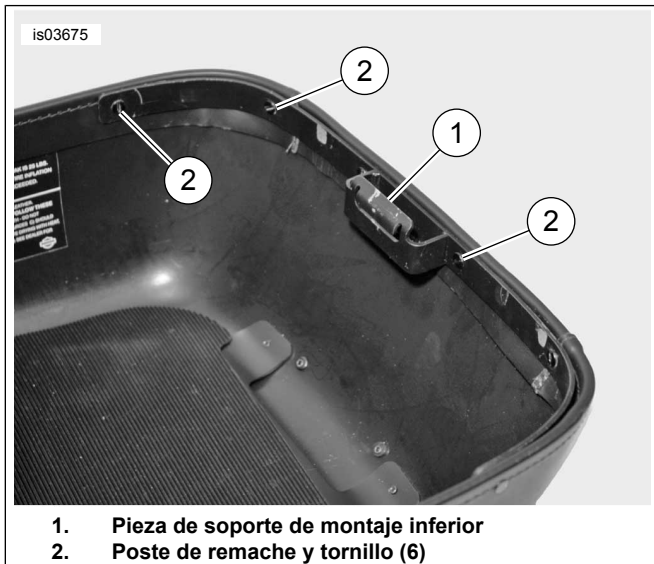
Figura 3. Instalación de la pieza de soporte de montaje inferior
