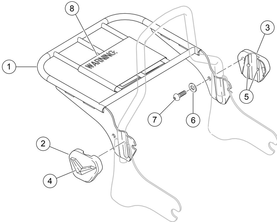
**Figura 1. Piezas de servicio: kit de Rejilla para equipaje para respaldo desmontable del pasajero**
