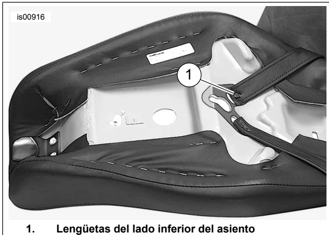
Figura 4. Parte inferior del asiento que muestra la correa de sujeción instalada
