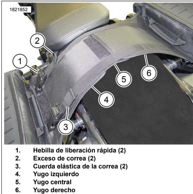
**Figura 10. Yugo ensamblado**
