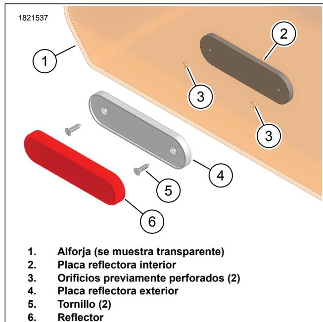
**Figura 4. Montaje del reflector**
