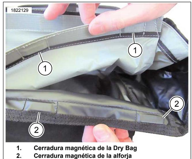
**Figura 12. Instalación de la Dry Bag**
