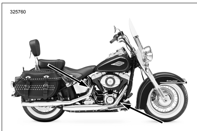
Figura 33. Locațiile senzorului de oxigen (partea interioară a țevilor de eșapament)
