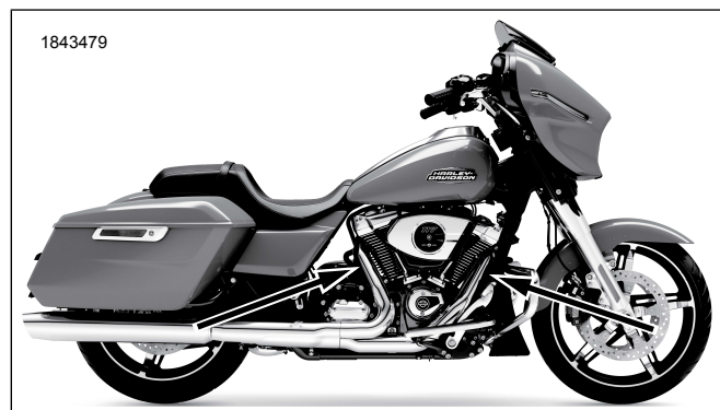
Figura 2. Locațiile senzorului de oxigen (partea interioară a țevilor de eșapament)
