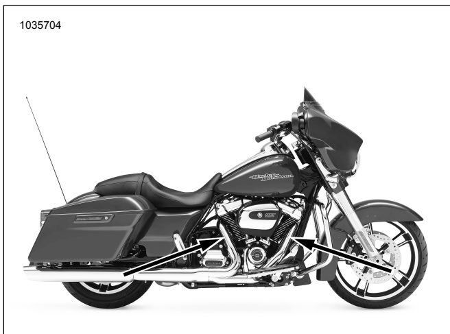
Figura 11. Locațiile senzorului de oxigen (partea interioară a țevilor de eșapament)
