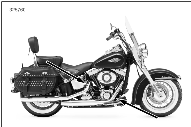
그림 33. 산소 센서 위치(배기 파이프의 안쪽 측면)
