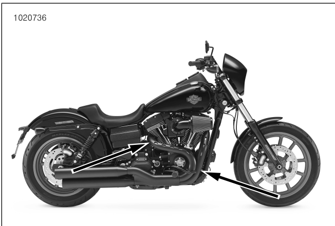
그림 40. 산소 센서 위치(배기 파이프의 안쪽 측면)
