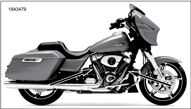
그림 2. 산소 센서 위치(배기 파이프의 안쪽 측면)
