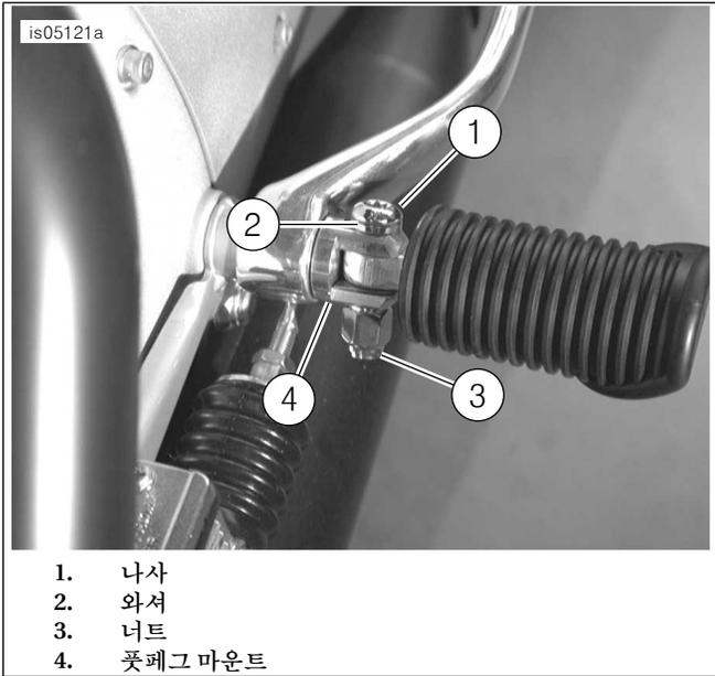
그림 2. 풋페그 나사 설치
